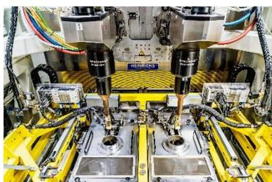
**ŠKODA AUTO führt in der Motorenfertigung Plasmabeschichtung der Zylinderkurbelgehäuse ein**
