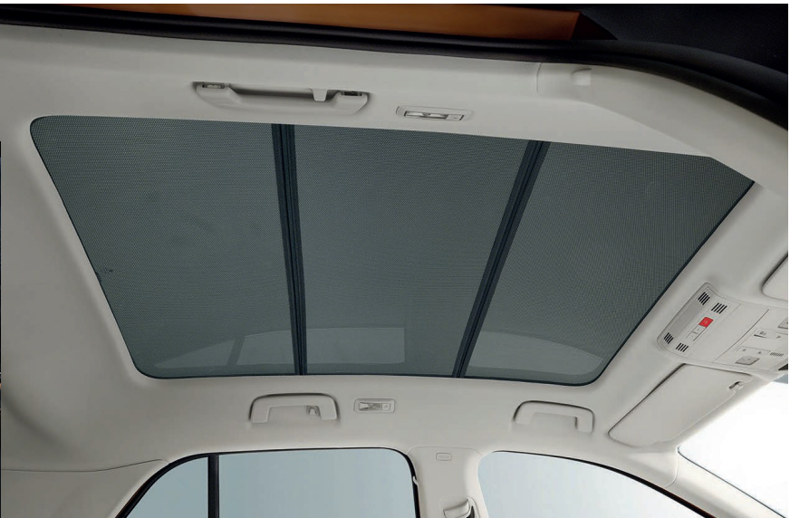
Sluneční clonu panoramatické střechy lze složit na třetinu velikosti a uložit pod kryt zavazadlového prostoru.
